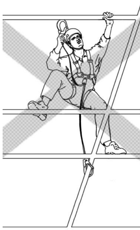
Figure Q.2 — En soulevant une élingue d'assurance au-dessus de sa position suspendue normale, la hauteur de chute potentielle augmente
